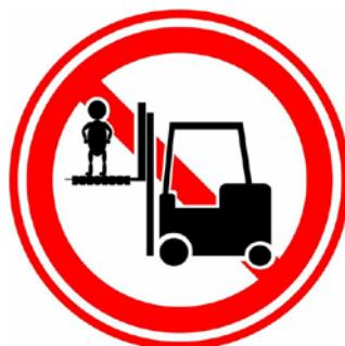
2024年1月、プラスチック製品製造業の労働者が、フォークリフトの用途外使用により死亡しました。労働者は高さ4メートルのタンクに備え付けられた配管の詰まりを取り除くため、フォークに4枚のパレットを載せ、タンクに乗り移る足掛かりとして使用していました。タンクからパレットに戻る際、バランスを崩して墜落しています。
